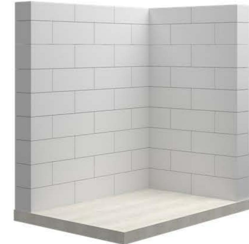
Стена из газоблока толщиной 200 мм с дополнительной звукоизоляцией РОКВУЛ + 4 см
